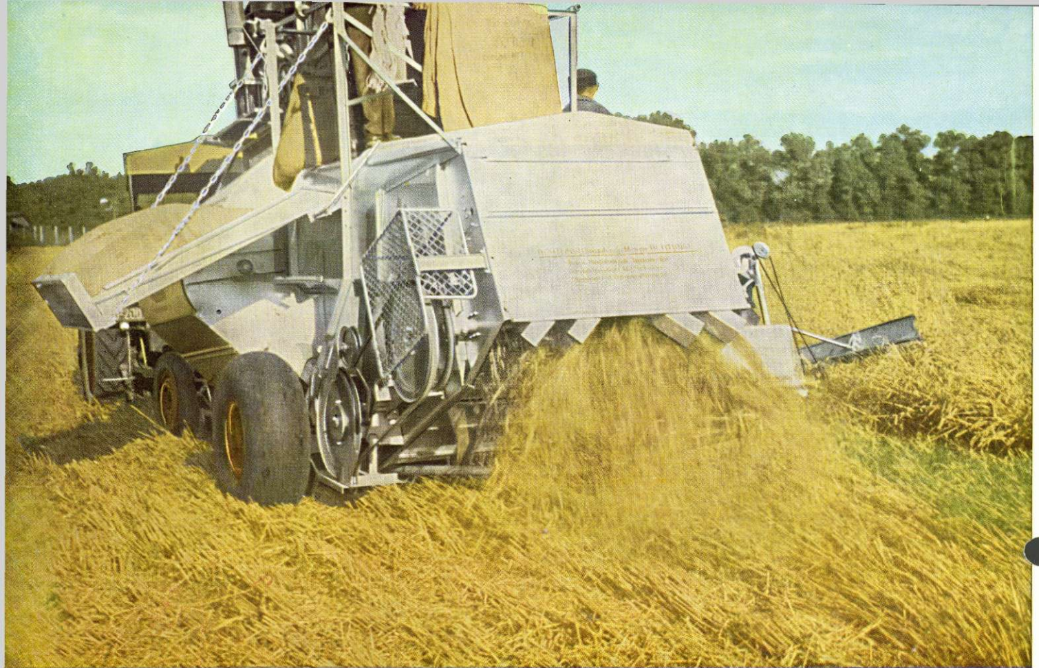
Der Strohschneider streut das Stroh geschnitten auf 10 bis 20 cm Länge wieder auf das Feld.
