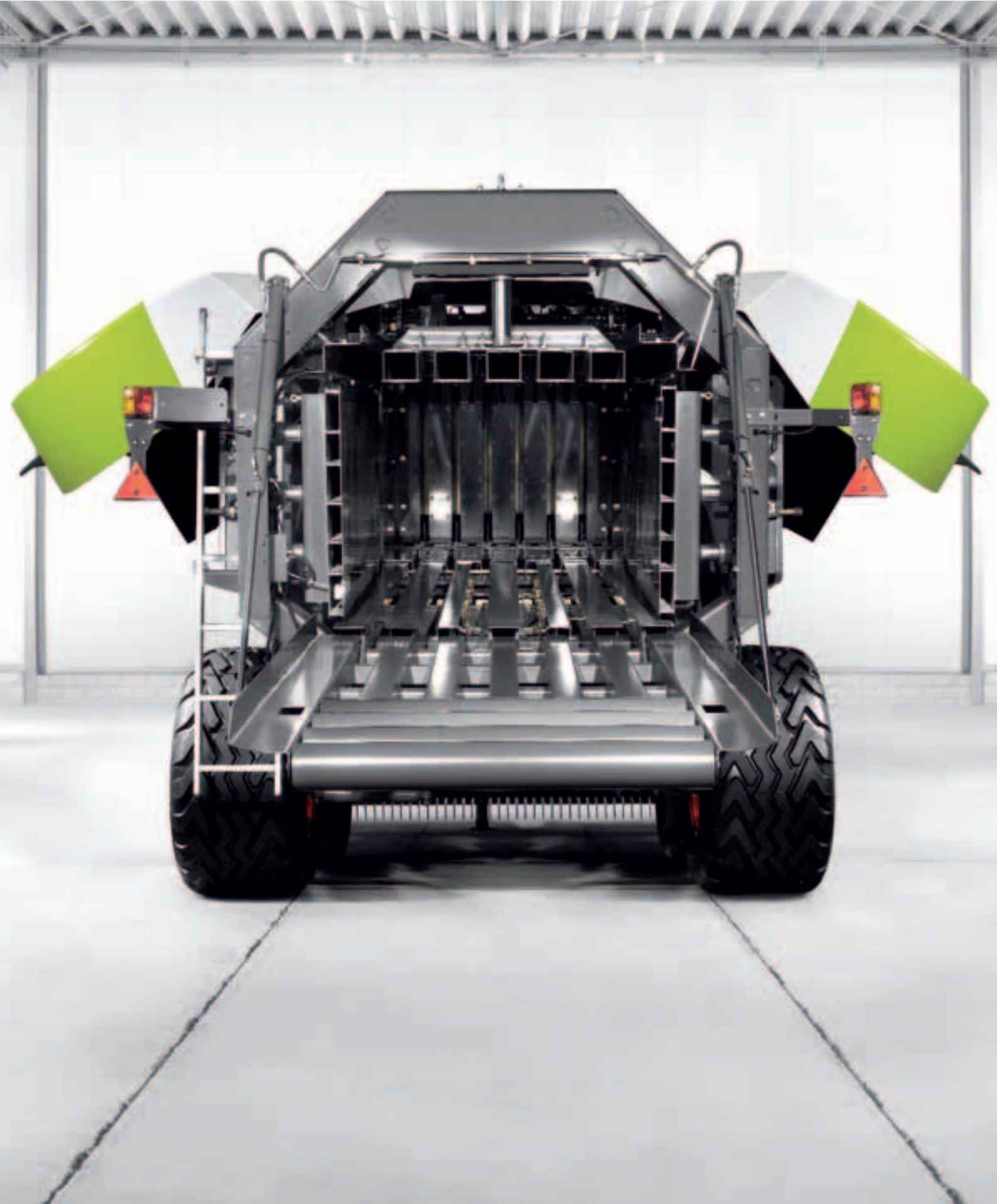
Knallharte Verdichtung in dem riesigen, 3 m langen Presskanal der QUADRANT 3400.
